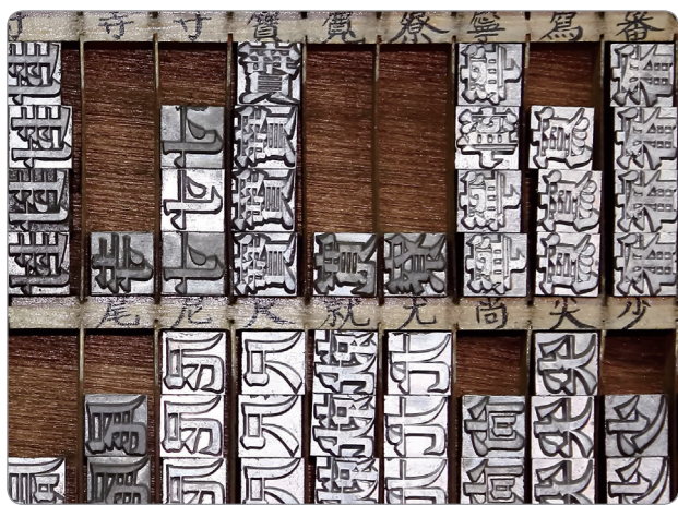
▲ 圖 1-1-3 早期要依賴人工逐一找到文件所需的鉛字，一顆顆排列後，才能印刷於紙上。
